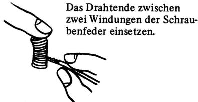
Anschließen eines zweiten Verbindungsdrahts an die gleiche Feder.
